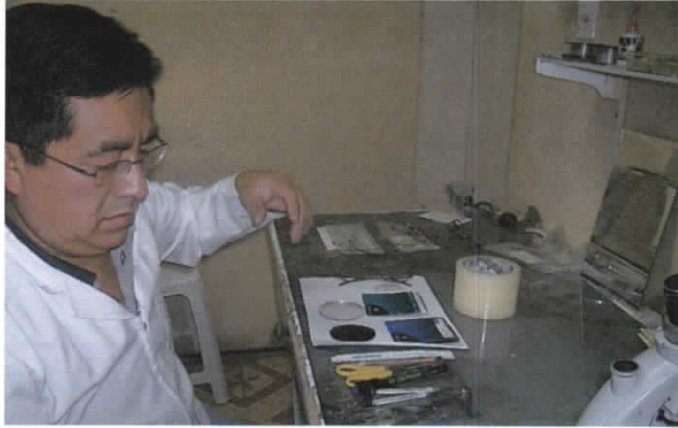
Recubrimiento de la lente con cinta adhesiva
