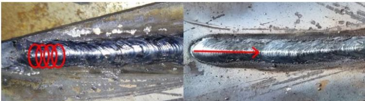
Figura 4. Técnicas de arco eléctrico, cordón oscilante y recto
