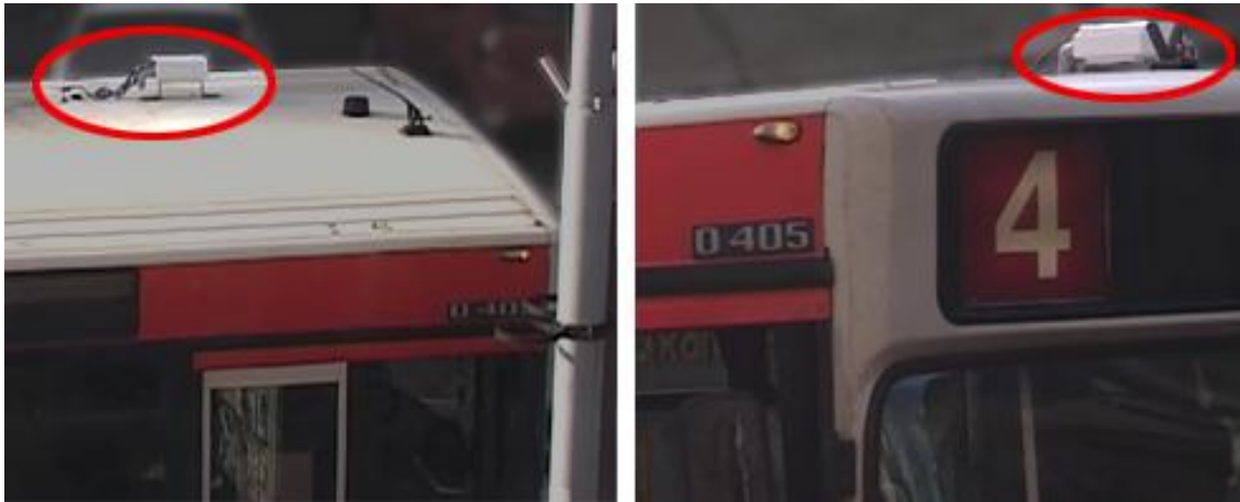
Fig. 1-19 Dispositivos EkoBus instalados en el techo de los buses
