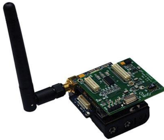
Fig. 2-10 Tarjeta de alimentación IBB2400 conectada a la tarjeta de sensores ISM400
