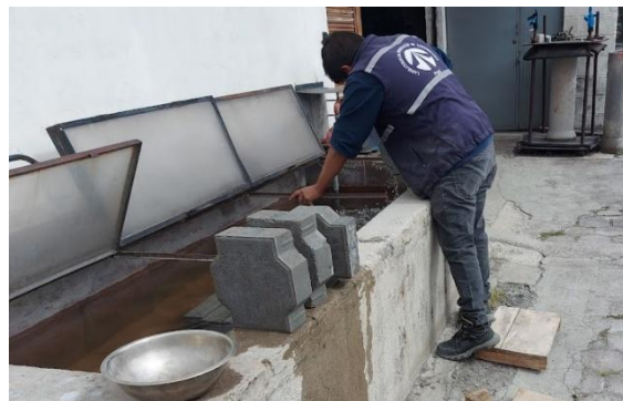
RETIRAR MUESTRAS SUMERGIDAS EN AGUA POR 30 MINUTOS
