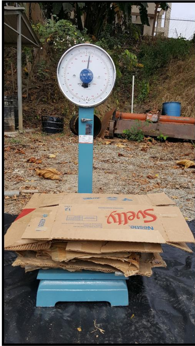
Foto 14. Pesaje de residuos por componentes
