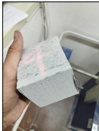
Ilustración 32 Desgaste de la cara superior del adoquín. Fuente: Autores
