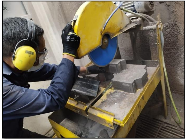
Ilustración 16 Corte de los adoquines. Fuente: Autores.
