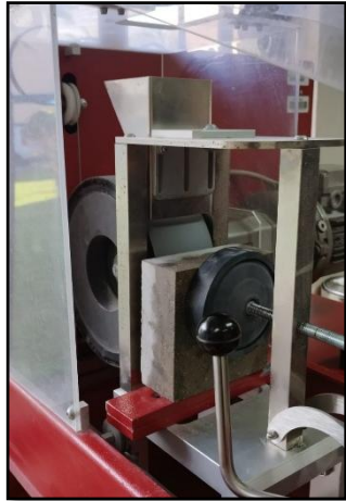
Ilustración 22 Probeta de mármol Boulonnais sometida al desgaste. Fuente: Autores
