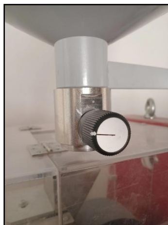
Ilustración 21 Marca en la válvula de control de la tolva de almacenamiento del material abrasivo. Fuente: Autores.
