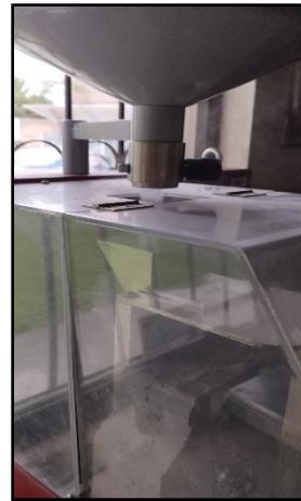
Ilustración 25 Adoquín sometidos al desgaste. Fuente: Autores
