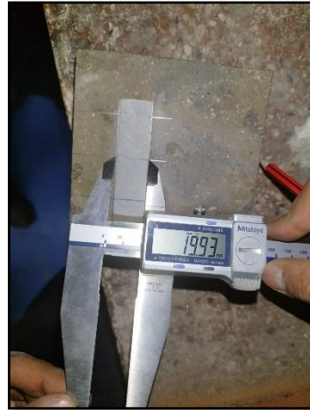
Ilustración 23 Medida de la huella en la probeta de Mármol Boulonnais. Fuente: Autores
