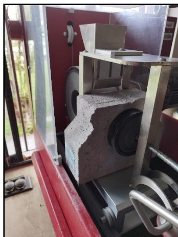
Ilustración 24 Adoquín en el carro porta probetas ajustado con el tornillo de fijación. Fuente: Autores.
