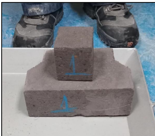
Ilustración 18 Muestras cortadas y listas para su secado. Fuente: Autores.
