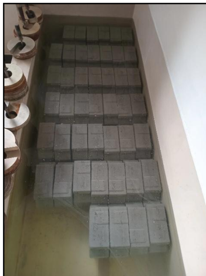
Ilustración 14 Adoquines sumergidos durante su respectivo curado. Fuente: Autores.
