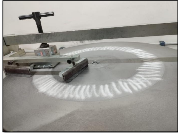
Ilustración 29 Distribución del material abrasivo en el disco giratorio. Fuente: Autores.
