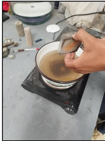
Ilustración 30 Colocación de parafina en la capa superior de desgaste. Fuente: Autores
