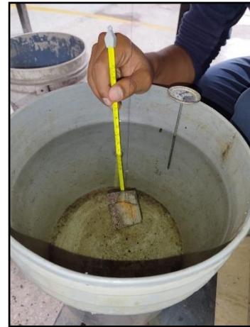
Ilustración 31 Peso de la capa superficial sumergido en agua. Fuente: Autores.
