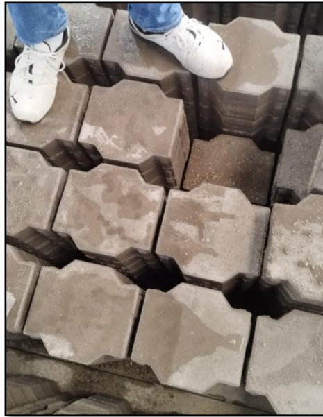
Ilustración 13 Toma de la muestra de 30 adoquines de hormigón hidráulico. Fuente: Propia.
