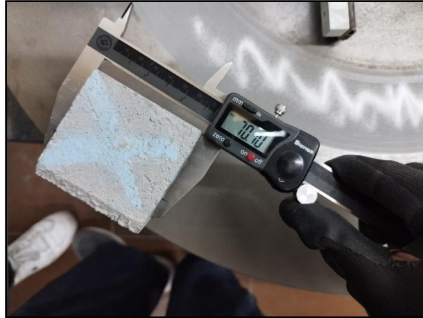
Ilustración 20 Toma de dimensiones de cada muestra para el ensayo Böhme. Fuente: Autores.
