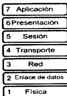
Figura 5: Capas del Modelo OSI
