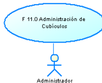
Título Figura 1.0.1- Representación de un caso de uso y de un actor
