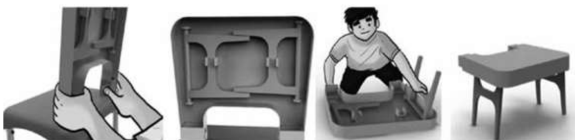
Figura 2. Espaldar transformable en apoyo auxiliar.
