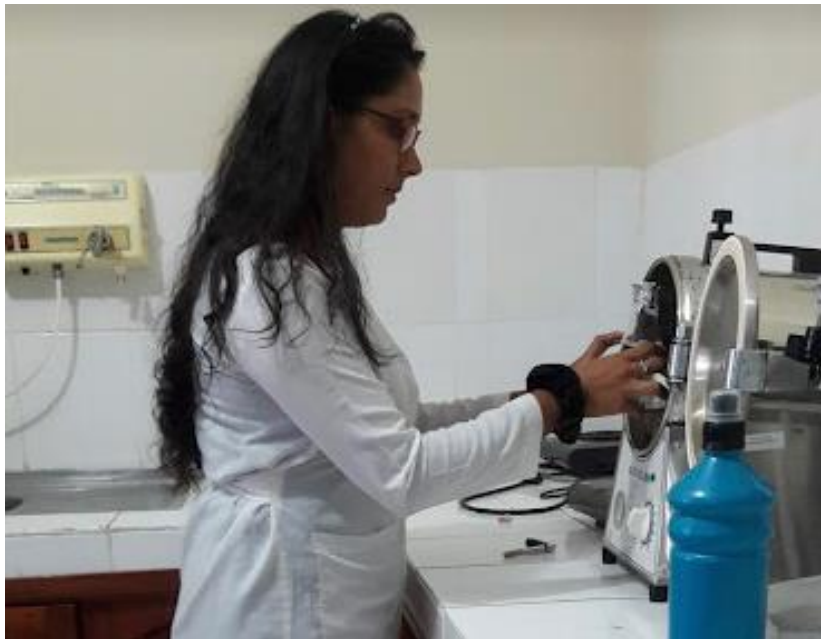
Figura 10. Esterilización del agua filtrada junto con las puntas de micropipeta Plus-Sed en el autoclave.
