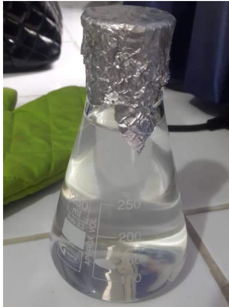
Figura 9. Agua previamente filtrada vaciada en el Matraz Erlenmeyer con su respectiva cubierta de papel aluminio para evitar impurezas.
