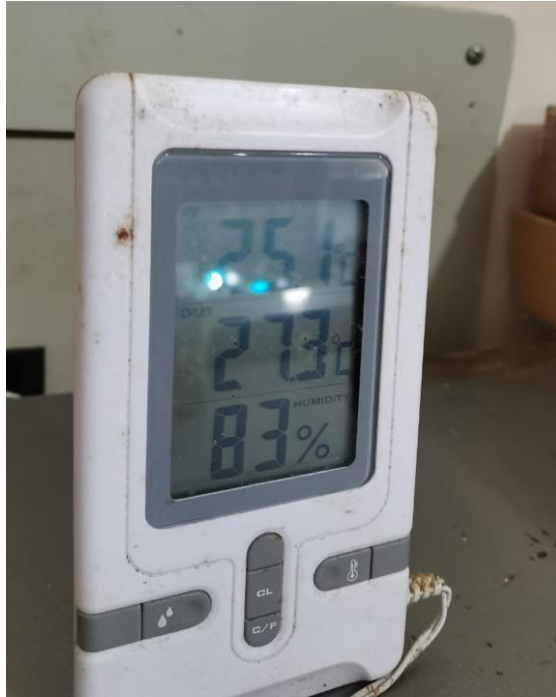
Figura 23. Termómetro digital para interiores ubicado en el Laboratorio de Gestión Ambiental PUCE - SE.
