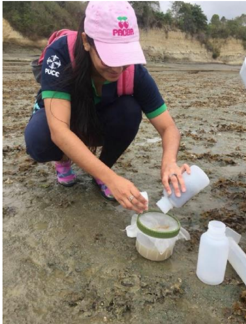
Figura 5. Filtración de agua de mar mediante un tamiz con luz de malla de 200 \mu\text{m} .
