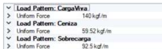
Ilustración 28 Asignación de cargas en la cubierta
