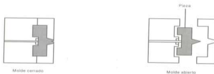
Figura 14. Apertura del molde para la extracción de la pieza
