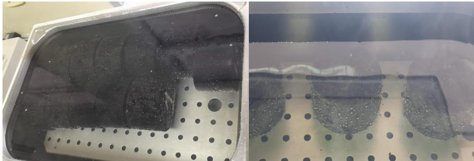
Ilustración 4.12 Briquetas de mezcla tradicional y con fibra sumergidas para ensayo Marshall
