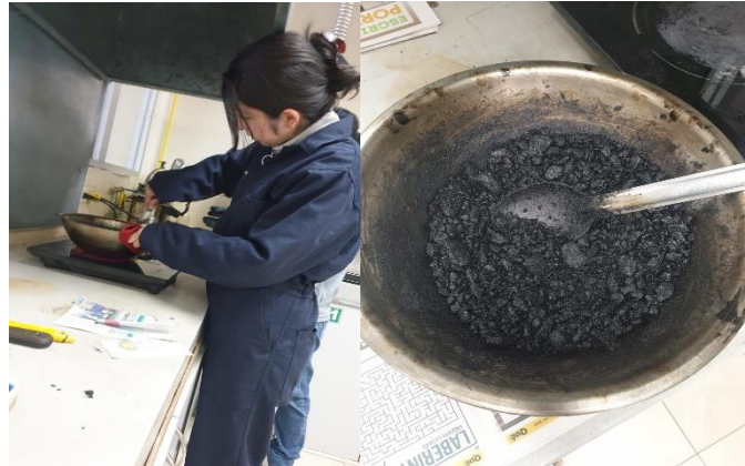
Ilustración 4.17 Elaboración de la mezcla asfáltica
