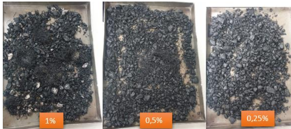
Ilustración 4.21 Mezcla asfáltica con 1%, 0,5% y 0,25% de fibra de Abacá
