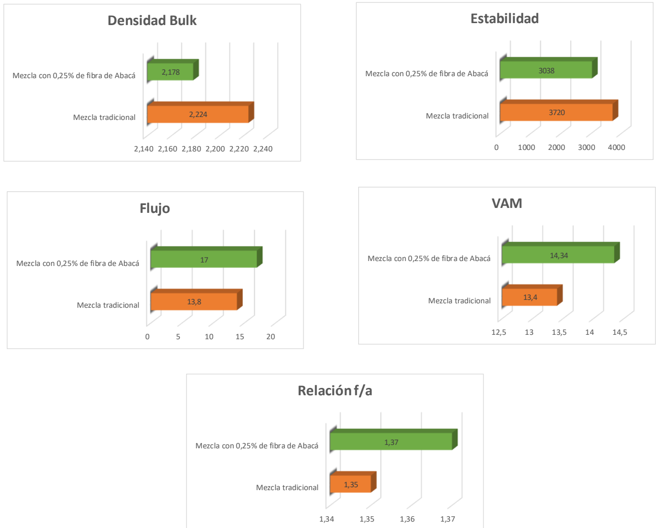
Ilustración 5.28 Comparación gráfica de las propiedades especificadas en la mezcla asfáltica tradicional con la mezcla de un porcentaje de fibra
