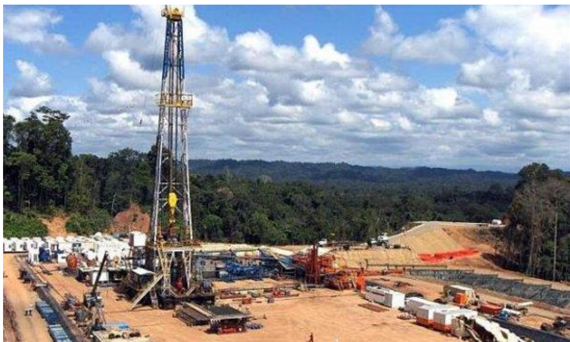
Figura 3: Torre de perforación con taladro en un pozo petrolero en el oriente ecuatoriano.
