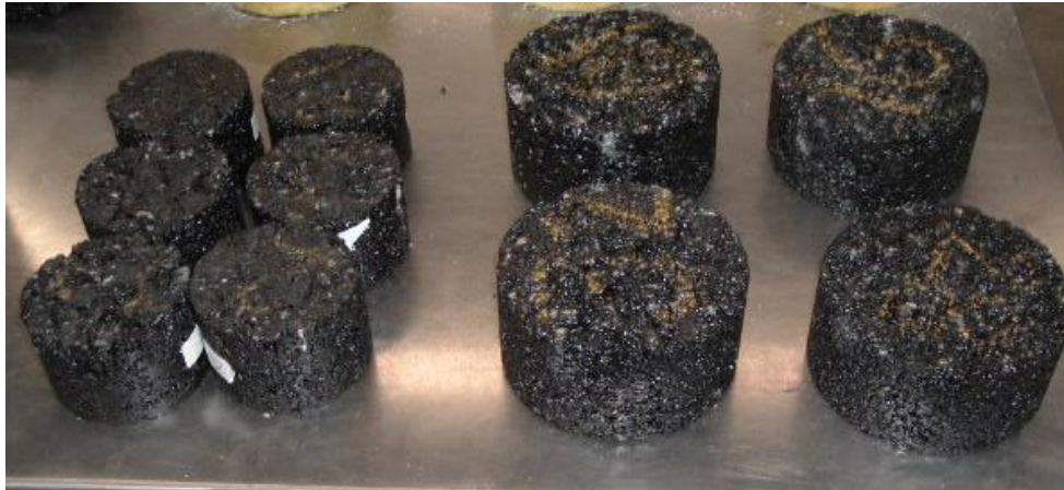
Fig. 2.6 Probetas Marshall y Superpave
