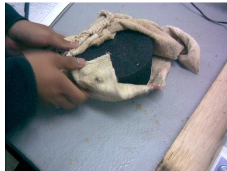
Fig. 3.23 Probeta Saturada con Superficie seca
