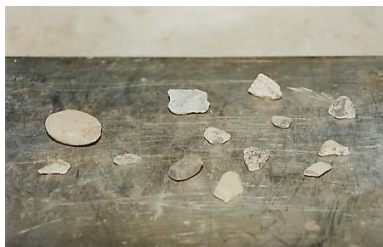
Fig.3.11 Partículas con caras fracturadas
