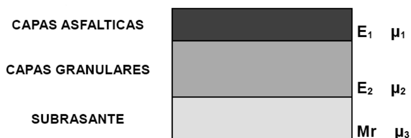
Figura IV.2 Estructura del pavimento para diseño SHELL
