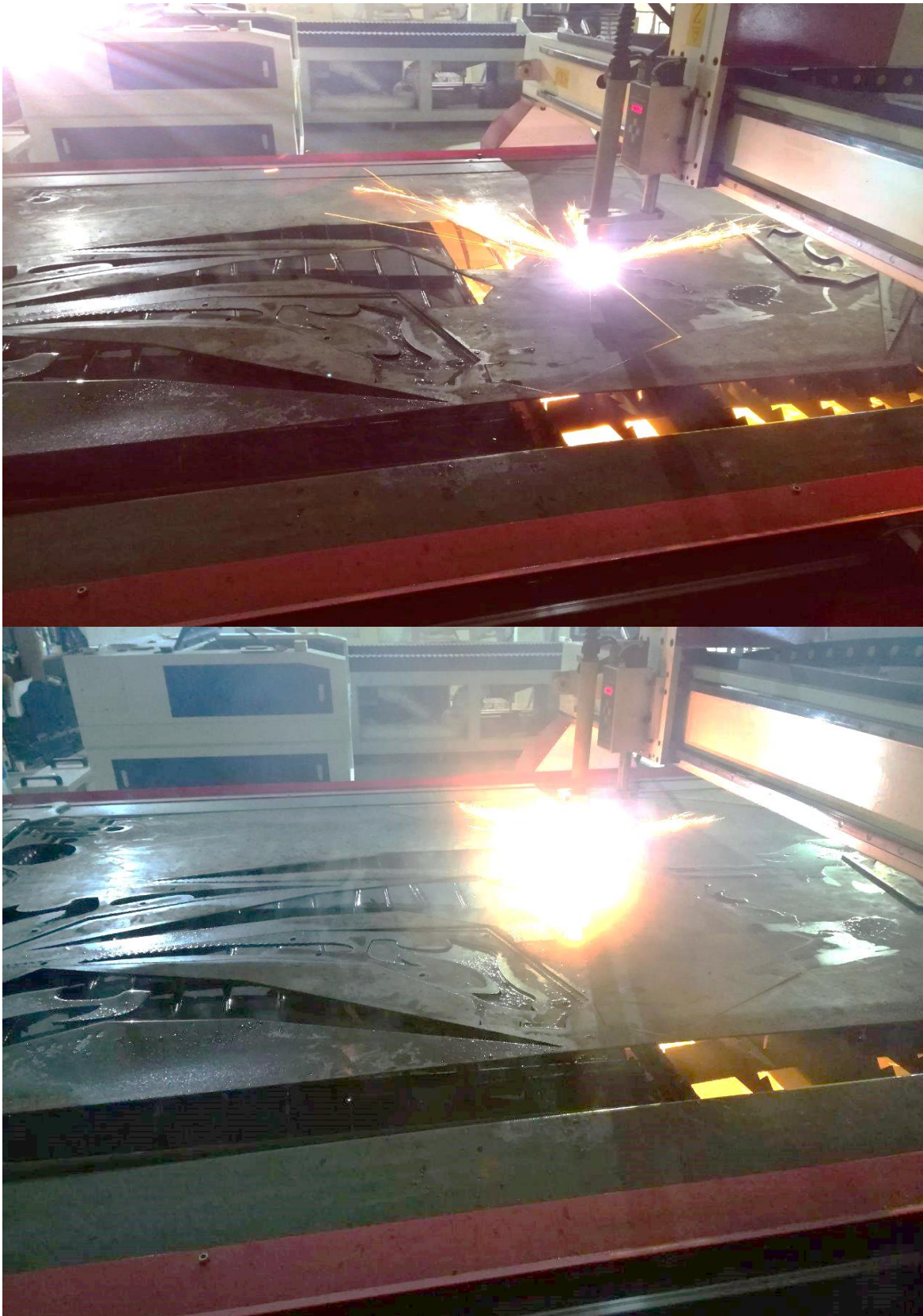
Figura 17. Proceso de corte CNC plasma
