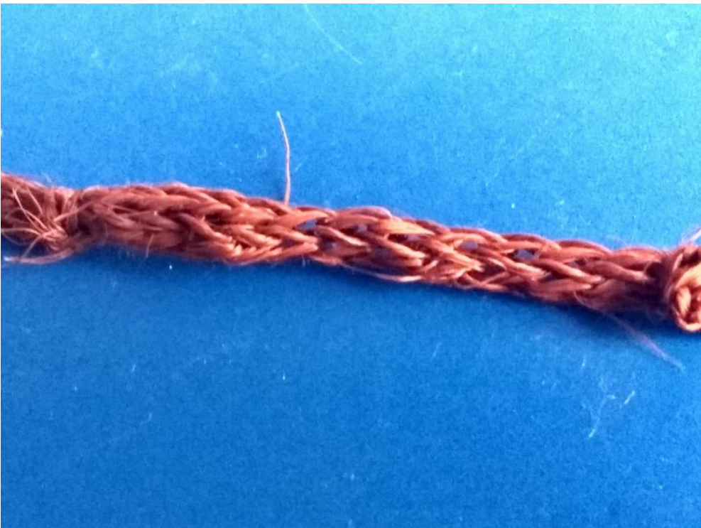
Figura 26. Cordón de pita tejido por maquina SP1DER
