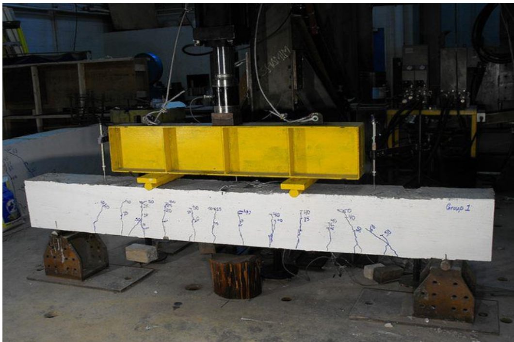
Figura 2.3.1. Prueba de carga aplicada a una vigueta de hormigón 16
