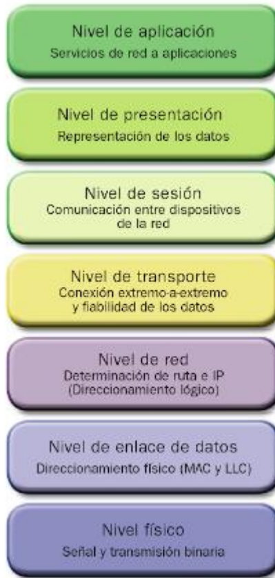
Figura: 3. 11 Capas del Modelo OSI
