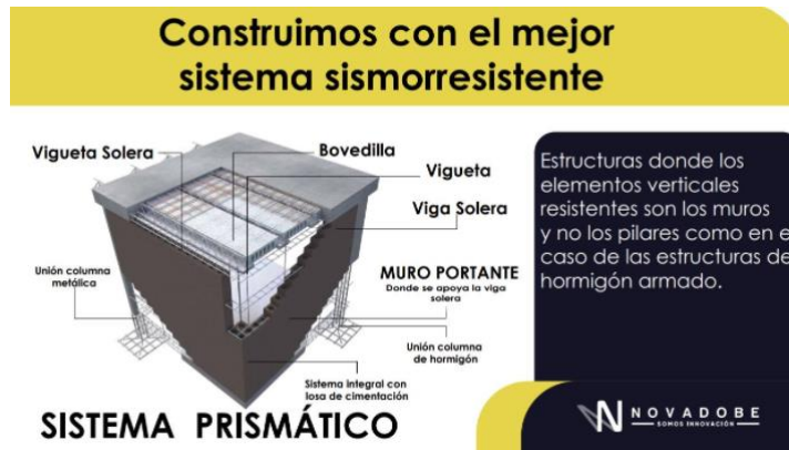
Figura 22. Sistema Sismorresistente NOVADOBE. Obtenido de (Novadobe, 2019)
