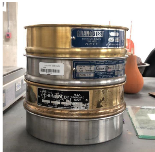
Figura 12. Granulometría por tamizado - CAROBÁ. Elaboración Propia
