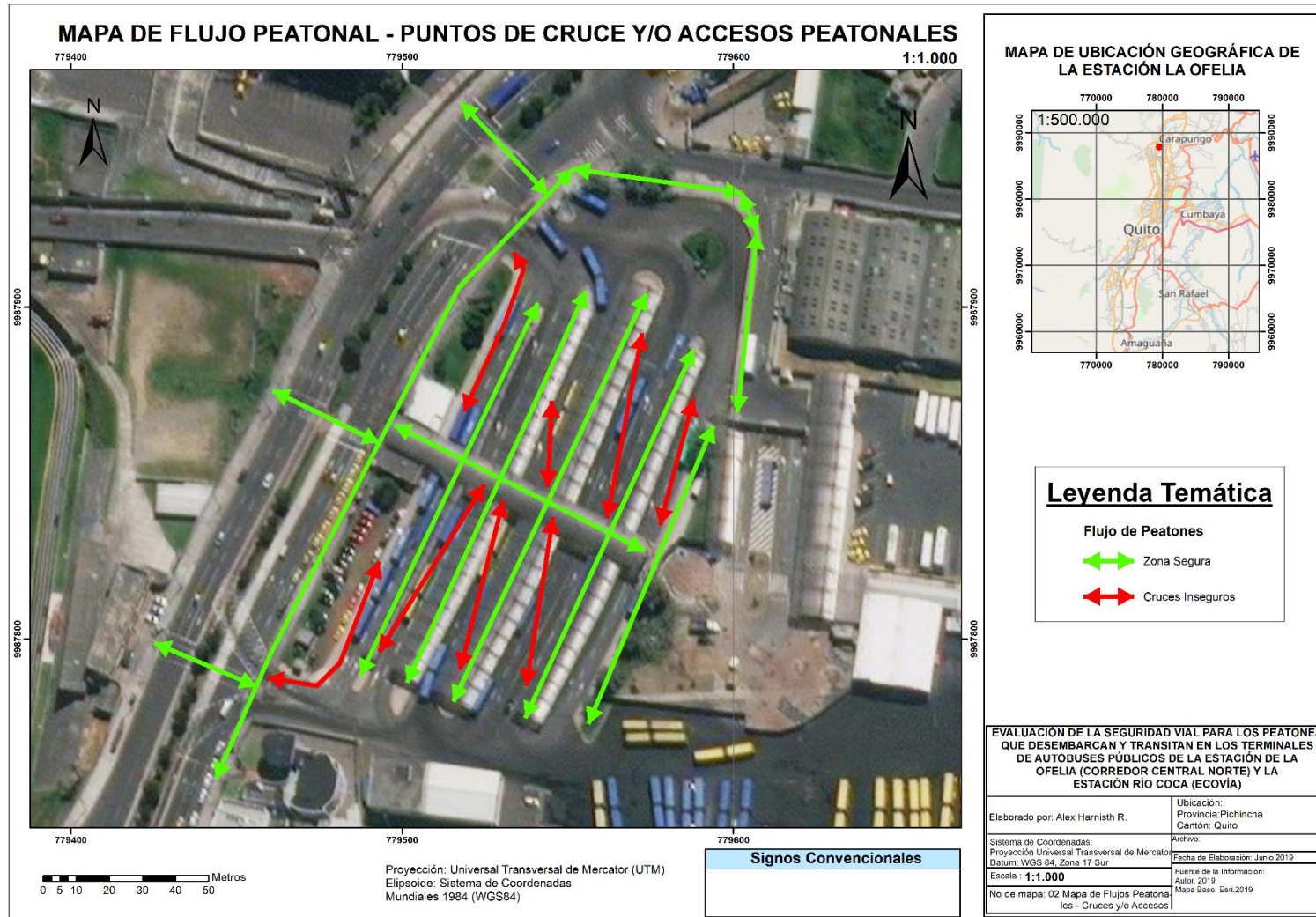
Figura 35 Mapa de flujo peatonal- Puntos de cruce y/o accesos peatonales estación La Ofelia.
