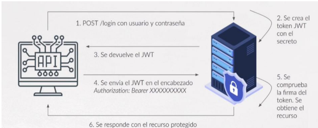
Funcionamiento de un token JWT (Json Web Token)
