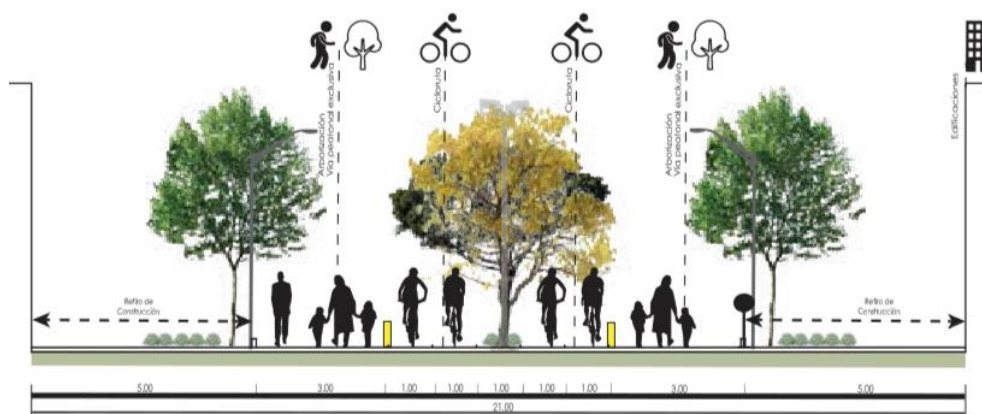
Figura 19. Esquema: corte de vías peatonales y ciclovías internas del terreno Tomado de Taller Profesional de Arquitectura I, 2017, p. 132.
