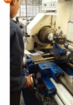
Cilindrado del lado anterior del pistón.
