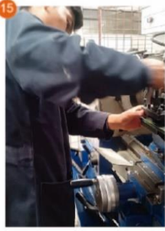
Ajustar el portaherramientas hasta que la cuchilla quede en la posición final.
