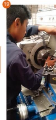
Proceso de refrentado: centrar el pistón en el mandril y la cuchilla con el contrapunto.
