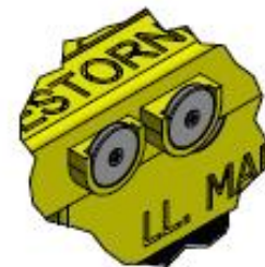
Detalle Y: Imanes neodimio Escala 1:2
