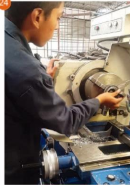
Uso de una pieza para golpear al pistón para centrarlo en el plato de mandriles.
