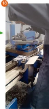
Ajustar el portaherramientas con la llave T.
