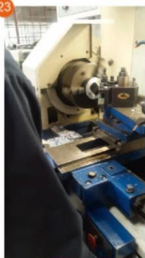
Cilindrado del lado posterior del pistón.
