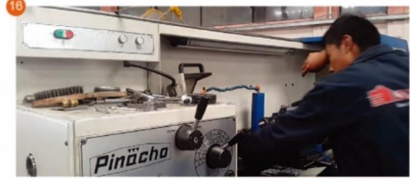
Apoyar la llave T en la máquina.
