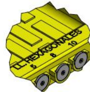
Detalle W: Numeración herramientas grabada Escala 1:2
