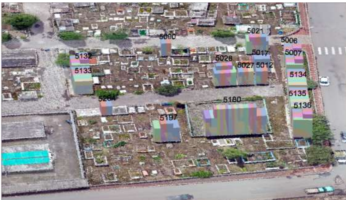
Gráfico 13. Captura de la escena 3D creada en arcscene para los edificios de bóvedas sobre la imagen geo referenciada. (Por el autor, 2019).
