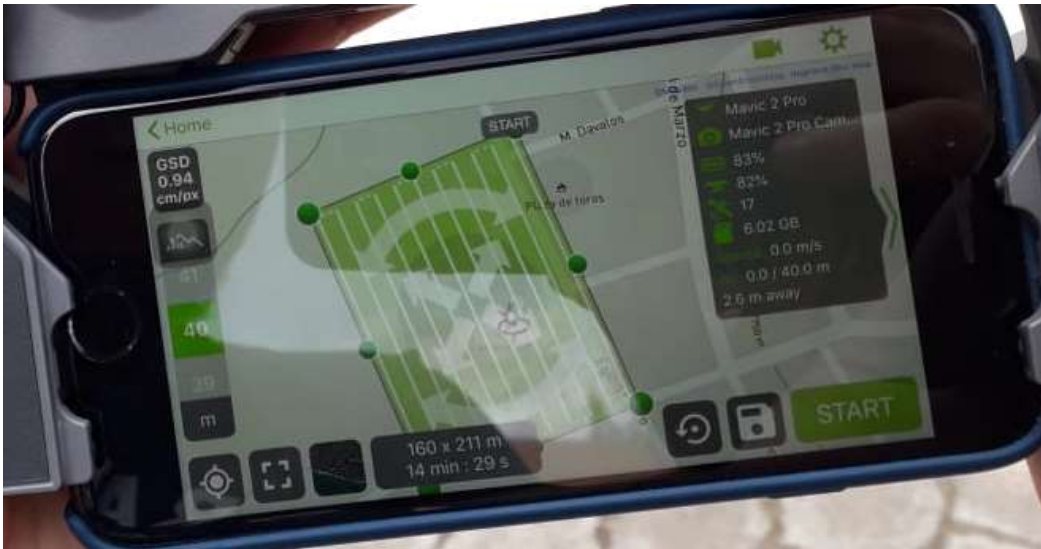
Fotografía 3. Plan de vuelo en la aplicación para móviles Pix4Dcapture realizado en la visita al campo para recolección de datos cartográficos. (Por el autor, 2019).
