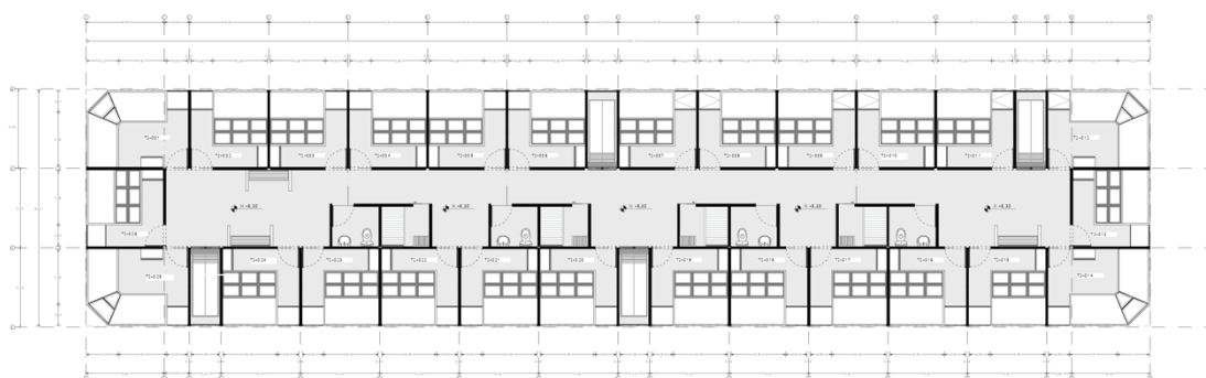
Figura N°40: Vueltas Largas en tres vanos de trece metros (39 metros en total).
