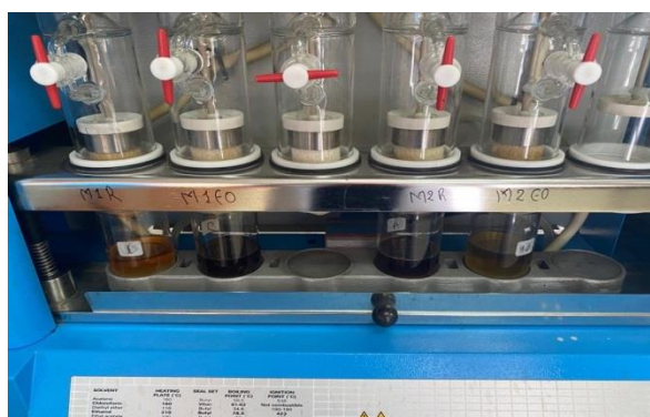
Figura 20: Primera extracción en el equipo SER-143. (Autor)
