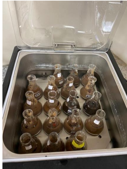
Figura 25: Colocación de las muestras en la incubadora para el tratamiento enzimático. (Autor)
