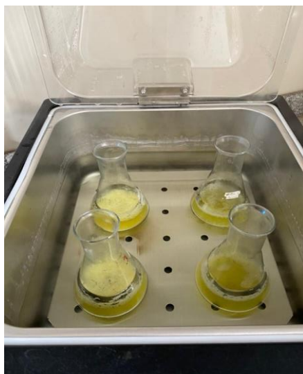
Figura 22: Muestras aplicando el método de oxidación de lignina para la obtención de Holocelulosa. (Autor)
