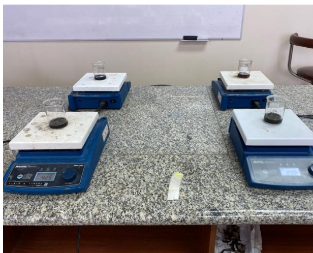
Figura 21: Muestras sometidas a tratamiento ácido para la obtención de lignina. (Autor)
