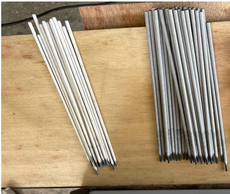
Figura 9 Electrodo 6011 y 7018 de 1/8 de pulgada
