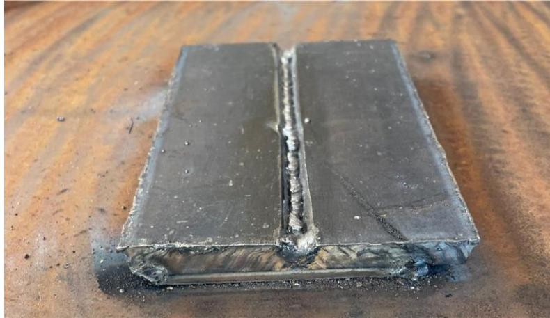
Figura 11 Soldadura de raíz con electrodo 6011 de 1/8 de pulgada
