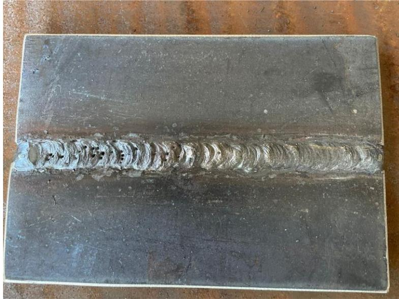
Figura 13 Placa soldada con formación de porosidades
