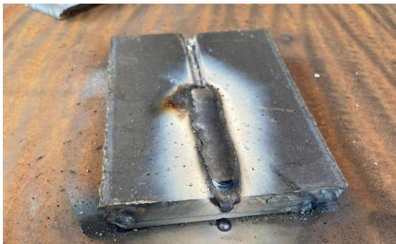
Figura 12 Relleno de soldadura con electrodo 7018 de 1/8 de pulgada
