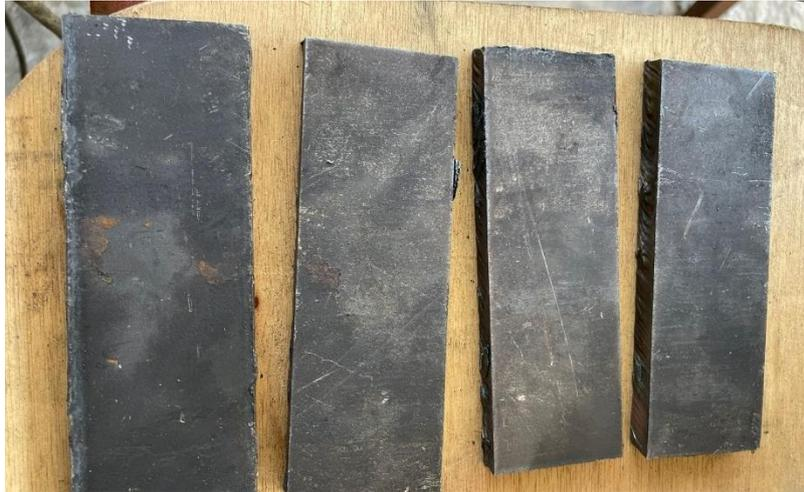
Figura 8 Placas de acero ASTM A-36 de 150x50x12
