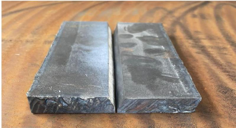
Figura 10 Placas biseladas con ángulo de 30 grados
