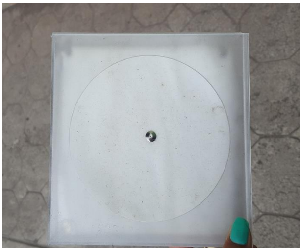
Figura 5. Muestreadores preparados para la recolección de material particulado. Elaborado por el Autor
