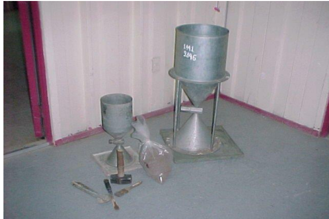
Figura 2.14 Equipo para el ensayo de cono y arena - https://ensayo+de+cono+y+arena&tFinsituM5.htm%3B640%3B480
