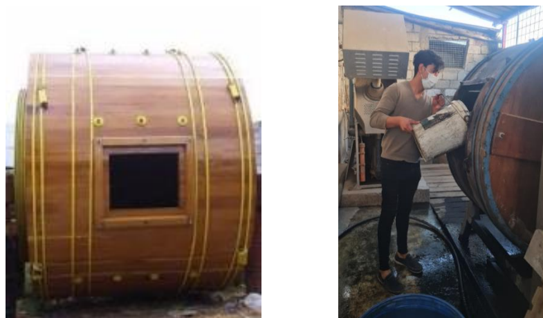
Figura 5. Maquinaria procesos bombo, tambor o fulón Elaborado por: El Autor
