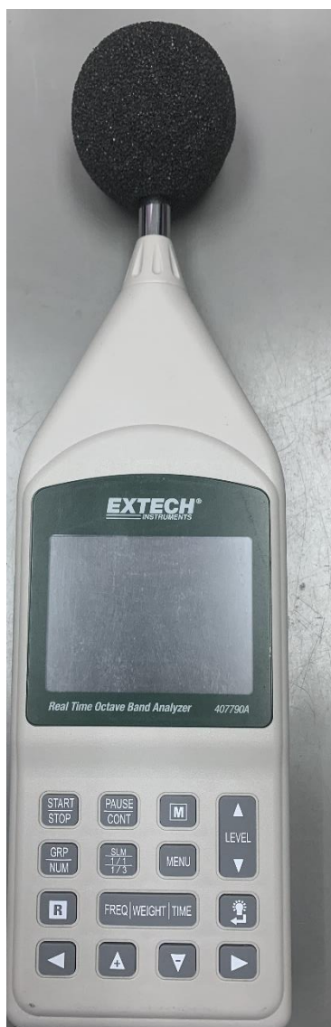
Figura 9: Sonometro EXTECH 407790A.
