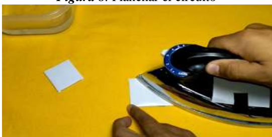
Figura 8. Planchar el circuito
