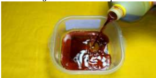
Figura 9. Colocar la baquelita en ácido férrico
