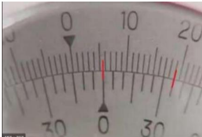
Figura 14. Ejemplos de lectura con el goniómetro
