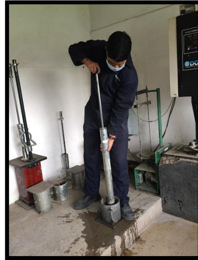
Fotografía 9.8 Compactación del Material para CBR
