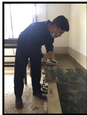
Fotografía 9.10 Colocación para saturación de muestras
