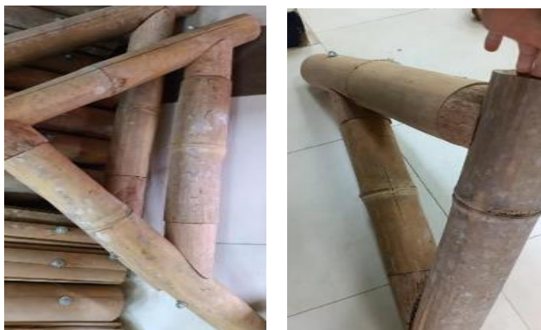
Gráfico 11. Conexiones con Acoples de Pico de Flauta y Varilla
