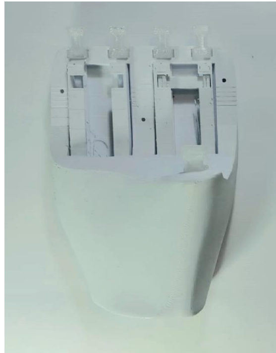
Figura 29 Mecanismo interno para el movimiento de los dedos
