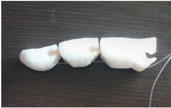
Figura 10 Modelo de estudio de un dedo en PLA y TPU realizado por Jubilous 3D
