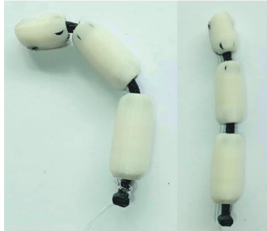
Figura 35 Flexibilidad del TPU en las uniones del dedo
