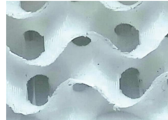
Figura 36 Relleno giroide impreso en PLA
