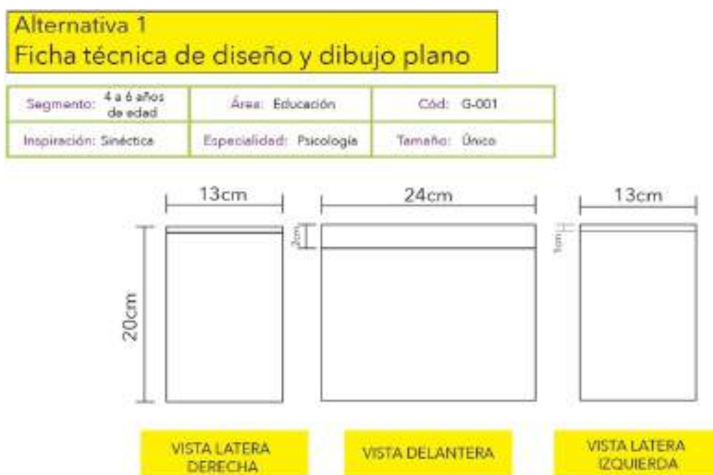
Figura 15. Alternativa 1 – Ficha técnica de diseño y dibujo plano
