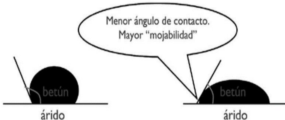
Imagen 2.5: Mejora el ángulo de contacto mediante el uso de tensoactivos
