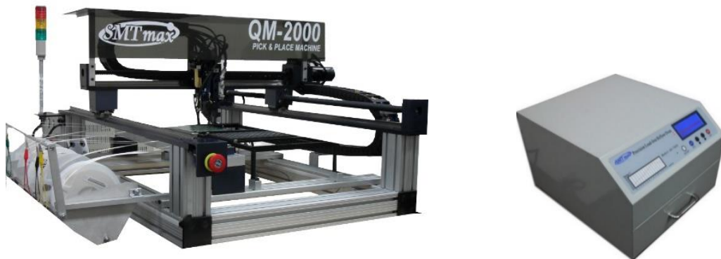
Figura 6. Máquina pick and place y horno para soldadura de tarjetas electrónicas. Adaptado de la información recolectada en KEYCO Ascensores para el proyecto, 2018.
