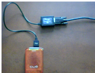
Figura 53. Conexión del Cable VGA del Monitor o Proyector
