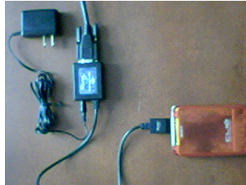
Figura 54. Conexión del adaptador de Corriente al Sistema Presenter-to-go
