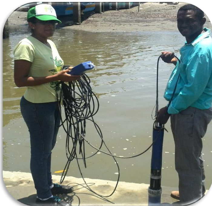
Sonda multiparamétrica utilizada para el análisis de parámetros in situ
