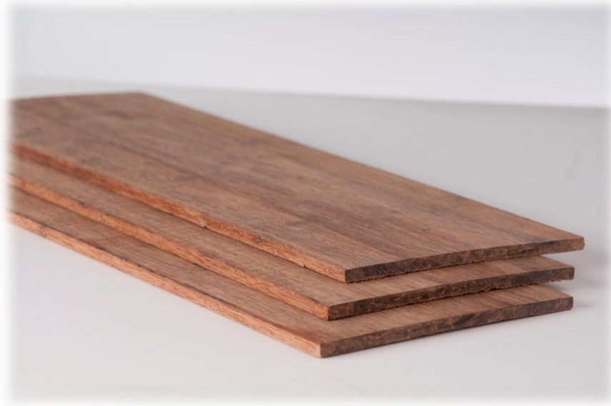
Fotografía N° 12. Láminas de bambú de 3 y 5 milímetros de espesor
