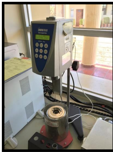
Fotografía 0.6 Ensayo de Viscosidad del Asfalto a altas temperaturas utilizando viscosímetro rotatorio
