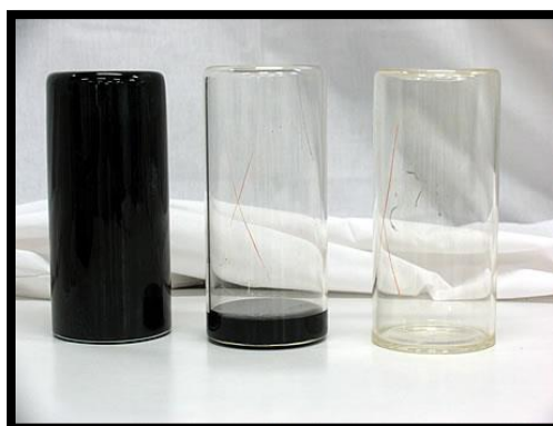
Fotografía 0.9 Ensayo de cambio de masa del asfalto
