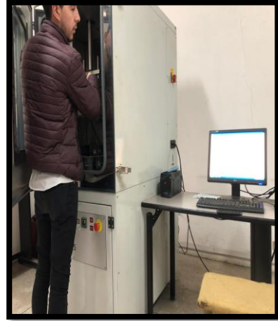
Fotografía 0.12 Ensayo de Briquetas en la Máquina Universal
