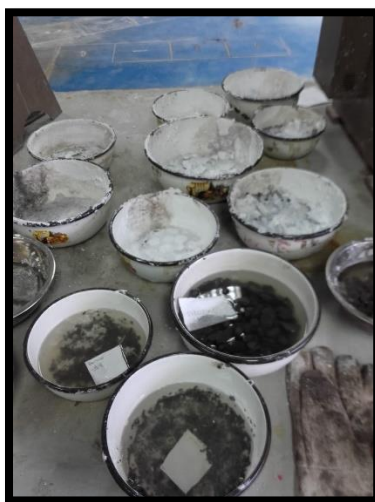
Fotografía 0.4 Ensayo de resistencia a los sulfatos
