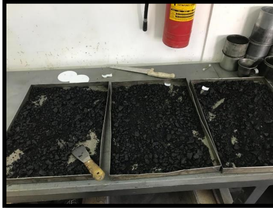
Fotografía 0.1 Ensayo de Gravedad Específica Máxima Teórica
