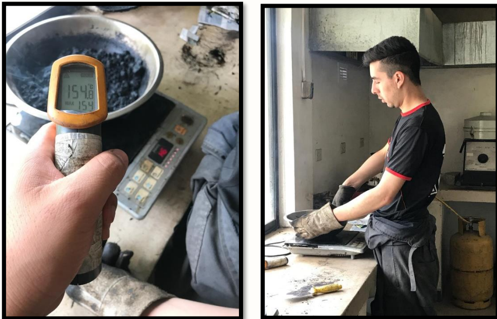
Fotografía 0.3 Mezcla de Agregados con Asfalto
