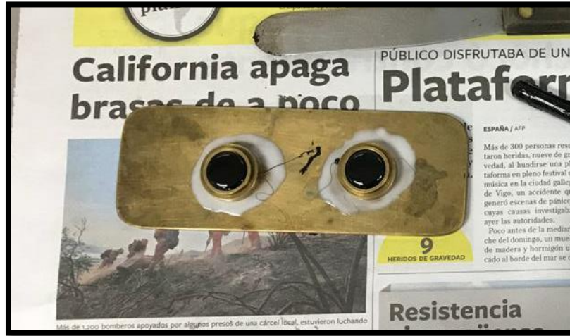
Fotografía 0.7 Ensayo de Punto de ablandamiento del asfalto
