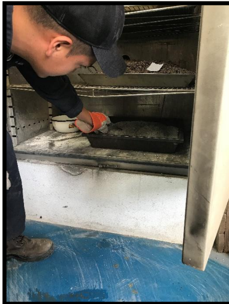
Fotografía 0.9 Procedimiento de Secado de Plástico PET Triturado
