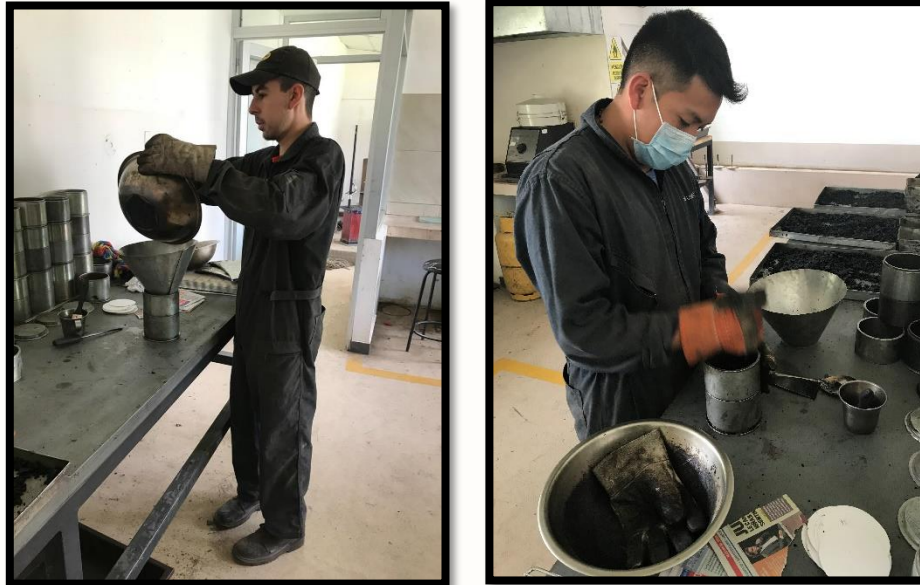
Fotografía 0.4 Colocación de la Mezcla en el Molde para Compactación
