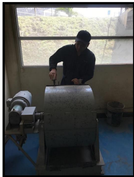
Fotografía 0.3 Ensayo de desgaste del agregado grueso
