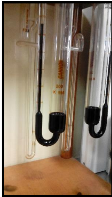
Fotografía 0.8 Ensayo de prueba estándar para la viscosidad del asfalto
