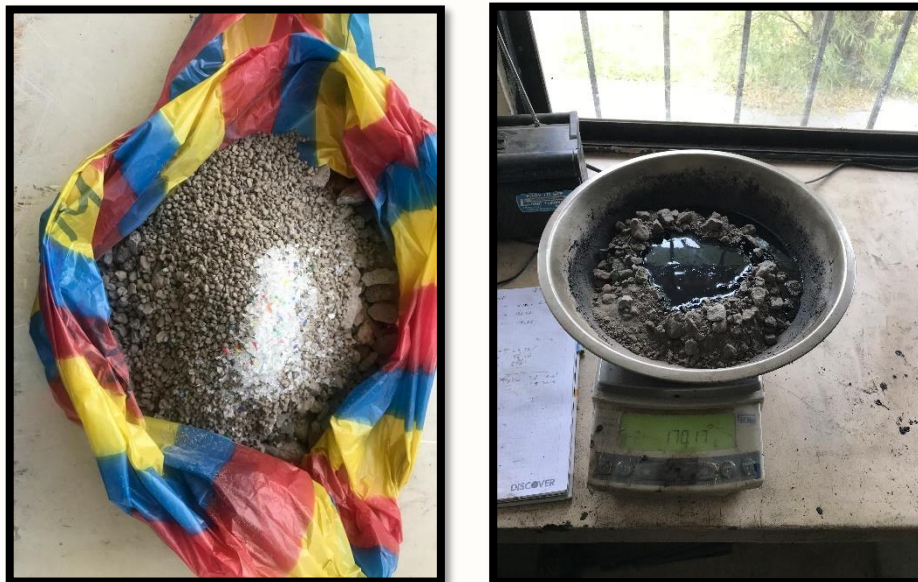
Fotografía 0.10 Adición de Plástico PET Triturado para la Mezcla
