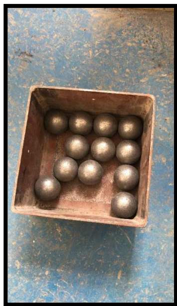
Fotografía 0.3 Ensayo de desgaste del agregado grueso
