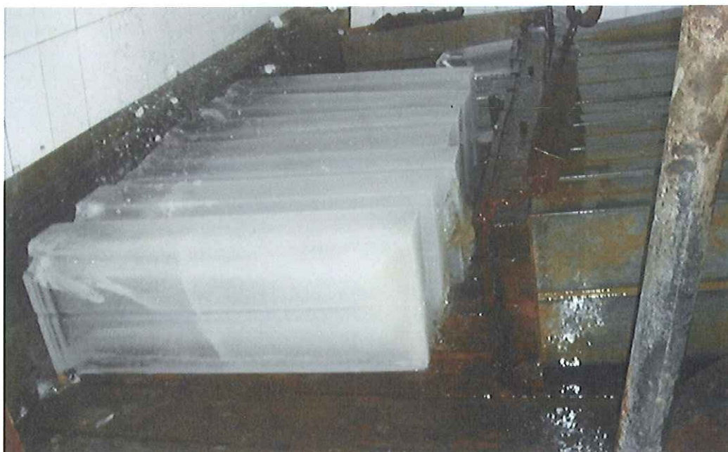
FOTO 07-DESMONTAJE DE MARQUETAS DE HIELO
