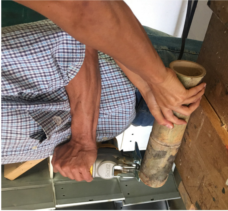
Figura 102: Corte de caña guadua con caladora. Elaboración: (Armendáriz & Cisneros,2019).
