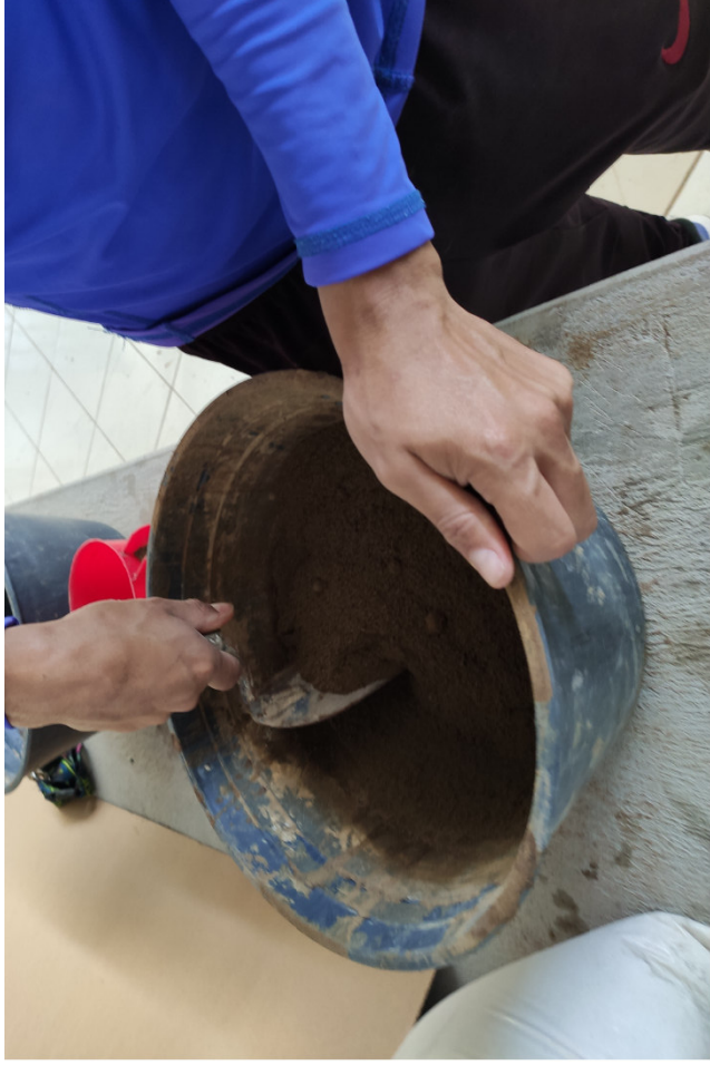
Figura 154: Dosificación entre tierra y arena. Elaboración: (Armendáriz & Cisneros,2019).
