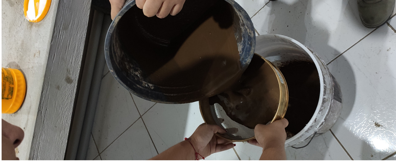
Figura 143: Vertido de la goma para la pintura de tierra. Elaboración: (Armendáriz & Cisneros,2019).
