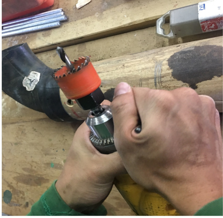
Figura 103: Broca para perforación circular. Elaboración: (Armendáriz & Cisneros,2019).
