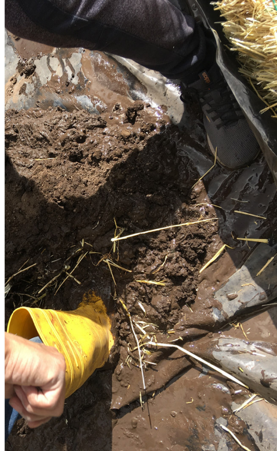
Figura 112: Mezcla apisonada de tierra cernida, arena y paja. Elaboración: (Armendáriz & Cisneros,2019).
