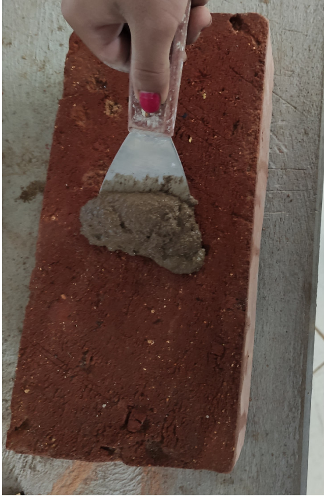
Figura 156: Aplicación de la muestra en superficie de ladrillo. Elaboración: (Armendáriz & Cisneros,2019).
