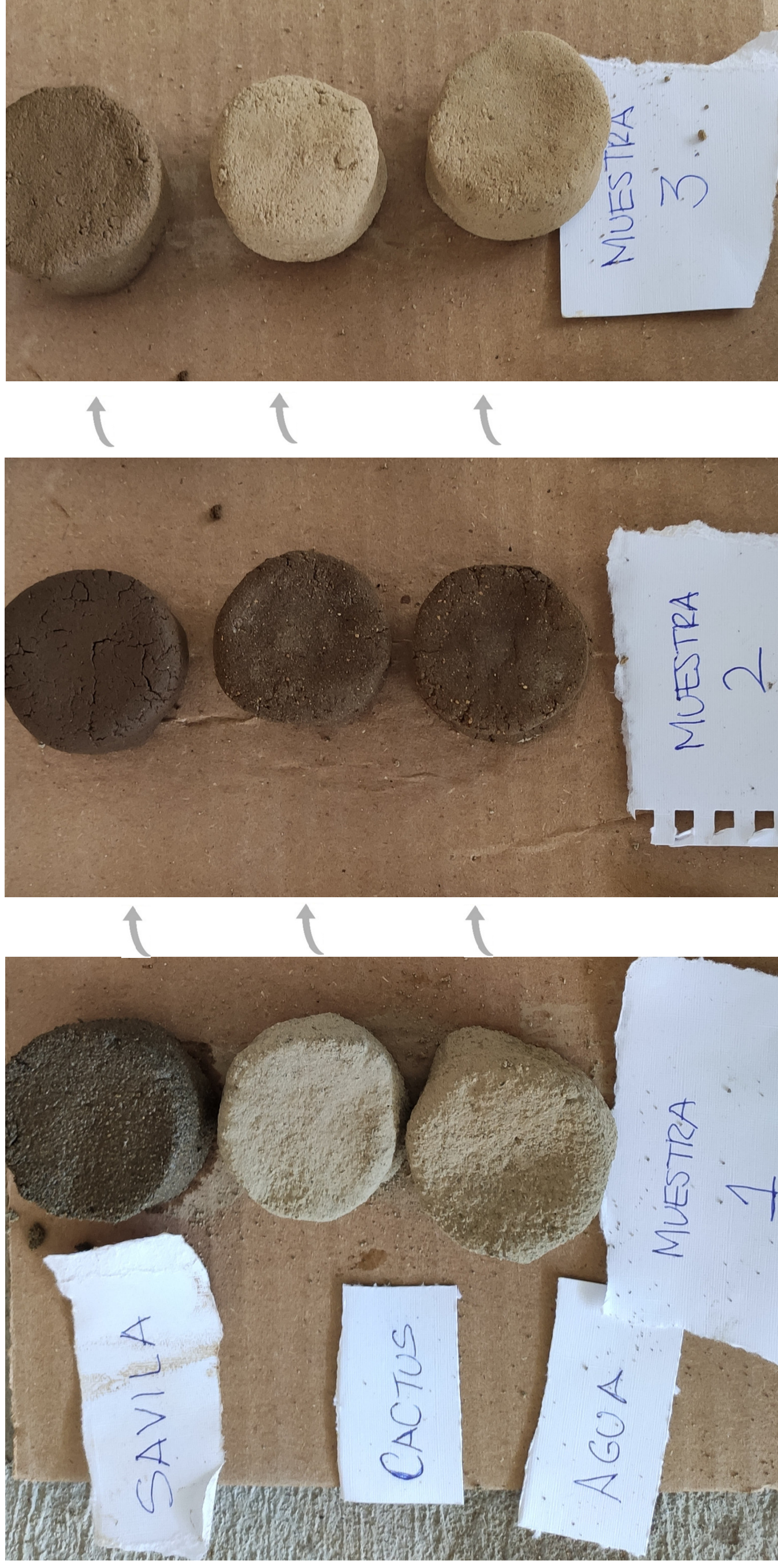
Figura 141: Prueba de la pastilla de las tres muestras. Elaboración: (Armendáriz & Cisneros, 2019).
