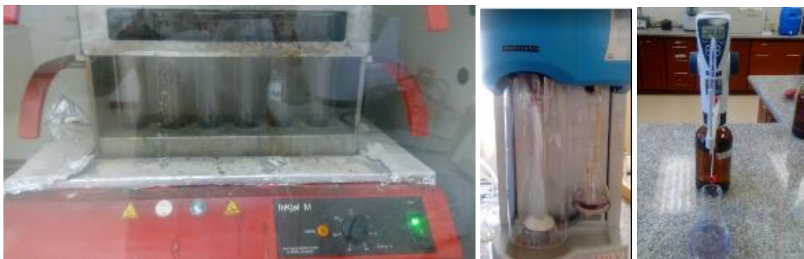
Figura 37. Análisis de proteína, método Kjeldahl, laboratorio PUCESI La imagen muestra el proceso de digestión, destilación y titulación (de izquierda a derecha). Tomado de trabajo de campo.
