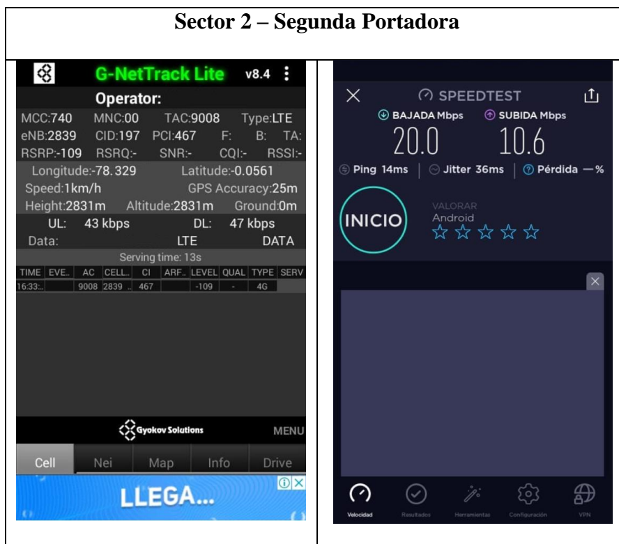
Figura C.5. Prueba de velocidad S2 Segunda Portadora LTE después de configurar 2P LTE. (Ibarra, 2020)
