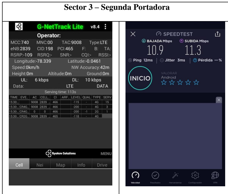
Figura C.6. Prueba de velocidad S3 Segunda Portadora LTE después de configurar 2P LTE. (Ibarra, 2020)
