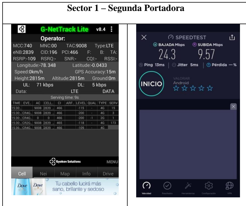
Figura C.4. Prueba de velocidad S1 Segunda Portadora LTE después de configurar 2P LTE. (Ibarra, 2020)
