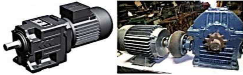
Gráfico N° 2.6. Motorreductor. El motor (derecha) está acoplado al reductor.
