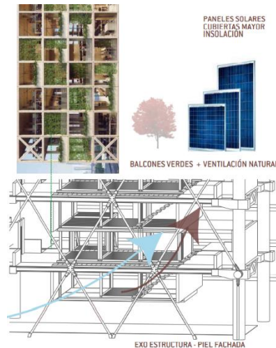
Figura 57: Fachada, doble piel, elaboración propia
